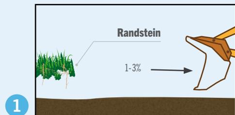
**1** Vor der Anbringung der Bodenbedeckung von LA BUVETTE® und vor dem Beginn der Arbeiten muss der Boden ausreichend trocken sein und, je nach Bodenart, eine Neigung von 1 bis 3 Prozent aufweisen.
