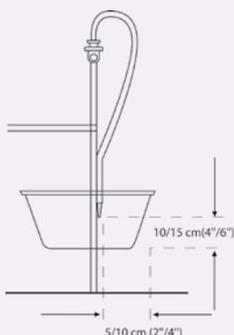
Montage des POUSTUBE in einem Trog für Säue oder einem „trockenen Futtertrog“.
