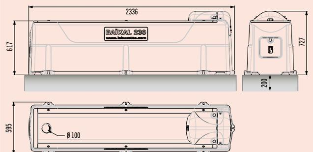
BAİKAL 230 wird auf einem Betonsockel mit einer Höhe von mindestens 20 cm montiert.
