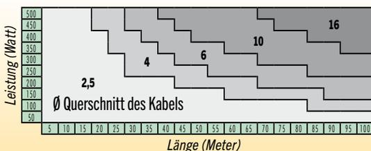
Verwenden Sie ein Elektrokabel mit einem Durchmesser, der für die Leistung Ihrer Anlage geeignet ist. Betrachten Sie das Diagramm. Die Installation einer Sicherung an der 230 V-Stromleitung und an der Nebenstromleitung des 24 V-Transformators ist vorgeschrieben.
