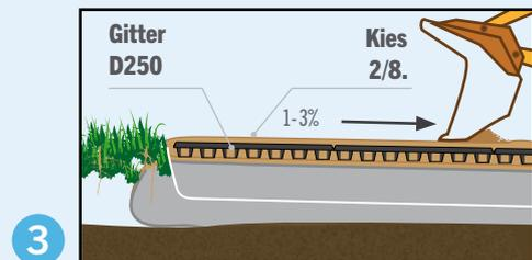
**3** Legen Sie die erste Fliese (D250) in eine Ecke, wobei die Haken in Richtung der mit Fliesen zu belegenden Fläche zeigen, und arbeiten Sie diagonal. Belassen Sie zwischen Rand und äußeren Fliesen eine Dehnungsfuge von 2 bis 3 cm. Befüllen Sie die Fliesen (D250) nach dem Verlegen mit einem wasserdurchlässigen Material (Kies 2/8). Tragen Sie die Auffüllschicht etwas dicker auf, da in den ersten Wochen nach dem Auftragen sich der Boden noch um 1 bis 2 cm verdichtet.
