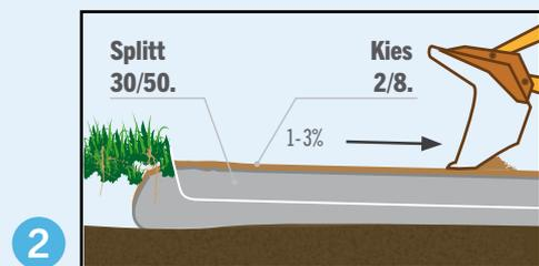
**2** Bringen Sie eine wasserdurchlässige Schicht aus Splitt 30/50 mit einer Dicke von höchstens 20 cm an und ebenen Sie den Boden mit einem geeigneten Gerät. Bringen Sie eine 1 bis 2 cm dicke Endschicht aus Kies 2/8 an.
