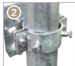
1 2 angezogen zum Schutz vor Lösen der Verbindung
