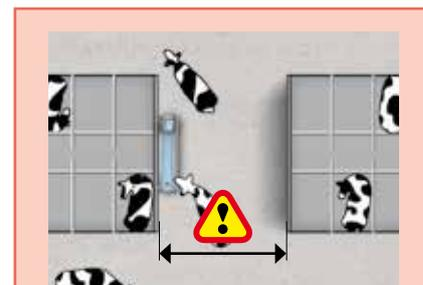
Der Durchgang muss ausreichend breit sein (3,75 m), damit die Kühe trinken können, ohne dass die anderen Kühe in ihrer Bewegung behindert werden, insbesondere am Ausgang des Melkstandes und in den belebten Durchgängen (4,5 m).
